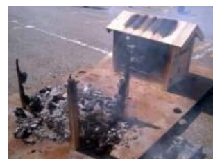
右側の小屋は屋根の一部と軒下部の燃え広がるが左側の小屋は発火せず
