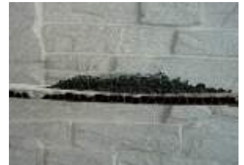
④最終的に約40倍に膨張し、断熱性に優れた炭化層を形成する
